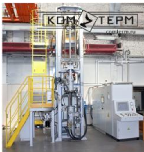
Рис. 3. Печь электрошлакового переплава под давлением – ДЭШП-0,1. ФГУП «ВИАМ»
