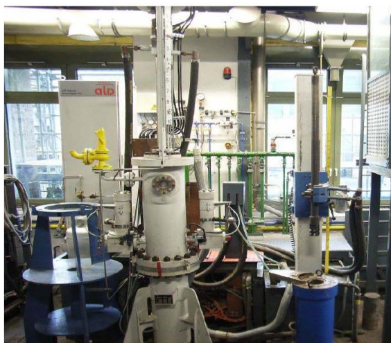
Рис. 1. Печь ЭШПД в техническом университете Аахена. (IME Aachen)
