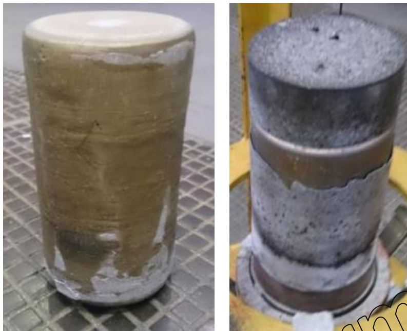
Рис. 5. Слитки \varnothing = 110 мм, выплавленные на печи ДЭШП-0,1
