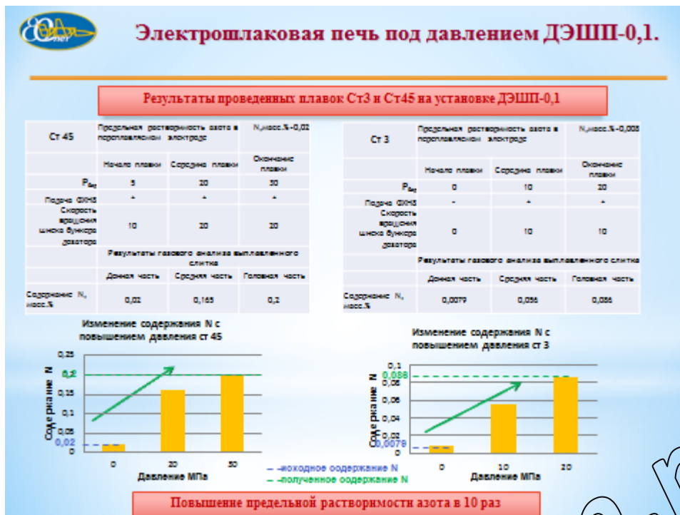
Рис. 7. График усвоение азота в нелегированных сталях при выплавке под давлением и легировании азотированным феррохромом.
